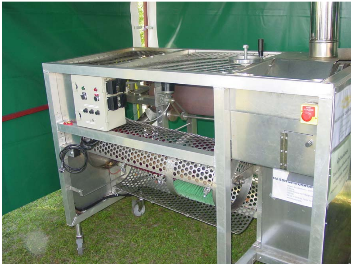
Mourjou Chestnut Museum mini brulage oven (capacity 25kg per hr)
